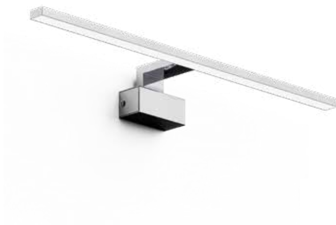
IL136P7 L. 60 cm IP44 | 220V | 5W | 712 lm | 4200 K | LED
