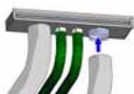
ES. BOCCHETTA LINEA CON RETE ARIA VMC (VERDE) RETE IDRONICA (GRIGIA)
