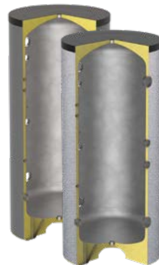
VKG-HC (PVC colorato) - VKGE-HC (lamierino goffrato) Acciaio al carbonio Verniciatura antiruggine esterna Coibentazione anticondensa
