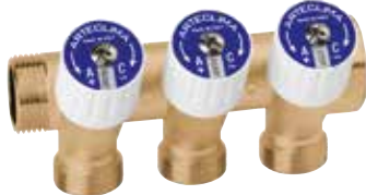
Collettore M/F 3/4" a tre derivazioni con arresti, filetto 24x19. Attacco tubo rame, plastica e multistrato. Manifold M/F 3/4" with three stoppers, connections for copper, plastic and multilayer pipe, thread 24x19.
