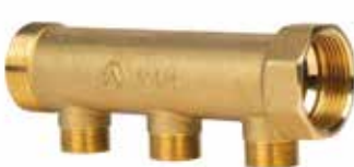
Collettore 3 vie M/F derivazioni interasse 50 mm. Attacco 24x19 sistema intercambiabile per tubo rame, plastica e multistrato fino Ø20. 3 ways manifold M/F center distance connections 50 mm. Connection 24x19 interchangeable system for copper, plastic and multilayer pipe up to Ø20.
