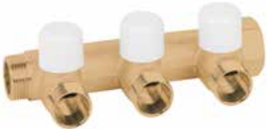
Collettore M/F a tre derivazioni con detentore per bilanciamento circuiti, filetto 24x19. Attacco tubo rame, plastica e multistrato. Manifold M/F with lockshields and three connections for circuits balance, thread 24x19. For copper, plastic and multilayer pipe.
