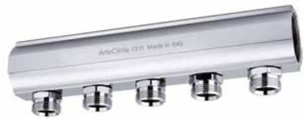
Collettore di distribuzione F/F 1" premontato con raccordi. Attacco tubo rame, plastica e multistrato, cromato. Pre-assembled distribution manifold F/F 1". Connection for copper, plastic and multilayer pipe. Chromium-plated.
