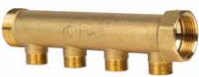
Collettore 4 vie M/F derivazioni interasse 50 mm. Attacco 24x19 sistema intercambiabile per tubo rame, plastica e multistrato fino Ø20. 4 ways manifold M/F center distance connections 50 mm. Connection 24x19 interchangeable system for copper, plastic and multilayer pipe up to Ø20.
