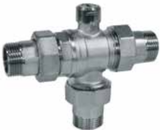
Valvola di zona 3 vie M/M deviatrice con ingresso sull'attacco inferiore e uscita sull'attacco superiore destro o sinistro. 3 ways diverter zone valve M/M with input from the lower connection and output to the upper right or left connection.
