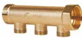
Collettore 3 vie M/F derivazioni interasse 50 mm. Attacco 3/4 maschio eurocono. 3 ways manifold M/F center distance connections 50 mm. Connection 3/4" male eurocone.
