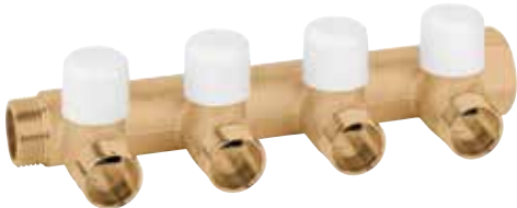
Collettore M/F a quattro derivazioni con detentore per bilanciamento circuiti, filetto 24x19. Attacco tubo rame, plastica e multistrato. Manifold M/F with lockshields and four connections for circuits balance, thread 24x19. For copper, plastic and multilayer pipe.
