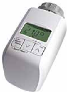
Comando termostatico digitale programmabile con sensore incorporato. Compatibilità valvole: M30x1,5. Alimentazione a batteria 2AA. Programmable digital thermostatic head with integrated sensor. Valve compatibility: M30x1.5 - 2AA battery powered.
