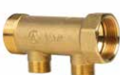
Collettore 2 vie M/F derivazioni interasse 50 mm. Attacco 24x19 sistema intercambiabile per tubo rame, plastica e multistrato fino Ø20. 2 ways manifold M/F center distance connections 50 mm. Connection 24x19 interchangeable system for copper, plastic and multilayer pipe up to Ø20.
