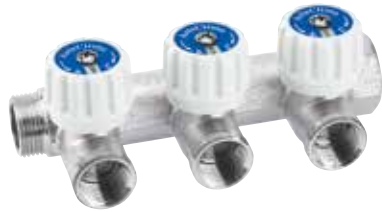
Collettore M/F a tre derivazioni attacco 1/2" femmina. Interasse derivazioni 45 mm. Manifold M/F with three connections 1/2" female. Center distance 45 mm.
