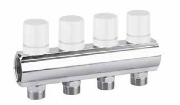
Collettore di distribuzione con vitoni termostattizzabili incorporati predisposti per comando elettrotermico (art. 315) e volantino per regolazione manuale, connessioni attacco tubo rame, plastica e multistrato, cromato . Chromium-plated distribution manifold with valves prepared for the thermoelectric regulation (art. 315) handwheel manual control. Connection for copper, plastic and multilayer pipe.
