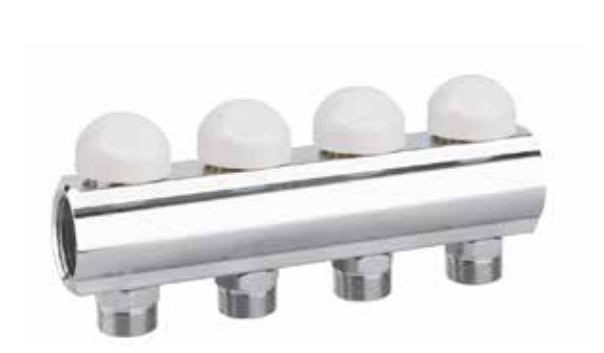
Collettore di distribuzione con vitoni termostattizzabili incorporati predisposti per comando elettrotermico (art. 315) e cappuccio di protezione, connessioni attacco tubo rame, plastica e multistrato, cromato . Chromium-plated distribution manifold with valves prepared for the thermoelectric regulation (art. 315) and protection cap. Connection for copper, plastic and multilayer pipe.
