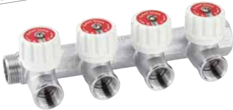
Collettore M/F a quattro derivazioni attacco 1/2" femmina. Interasse derivazioni 45 mm. Manifold M/F with four connections 1/2" female. Center distance 45 mm.
