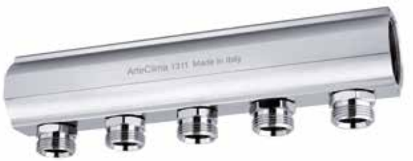
Collettore di distribuzione F/F 1"1/4 premontato con raccordi. Attacco tubo rame, plastica e multistrato, cromato. Pre-assembled distribution manifold F/F 1"1/4. Connection for copper, plastic and multilayer pipe. Chromium-plated.
