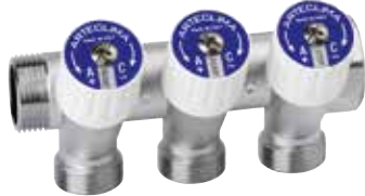
Collettore M/F 3/4" a tre derivazioni con arresti, filetto 24x19. Attacco tubo rame, plastica e multistrato. Manifold M/F 3/4" with three stoppers, connections for copper, plastic and multilayer pipe, thread 24x19.
