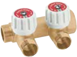
Collettore M/F a due derivazioni con arresti manuali, filetto 24x19. Attacco tubo rame, plastica e multistrato. Manifold M/F with two manual stoppers, thread 24x19. Connections for copper, plastic and multilayer pipe.
