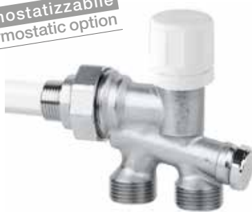
Valvola BITUBO termostattizzabile completa di sonda. Interasse derivazioni 38 mm. Derivazioni 24x19. DOUBLE pipe radiator valve with thermostatic option and probe, connections 24x19. Center distance connections 38 mm.
