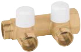
Collettore M/F a due derivazioni con detentore per bilanciamento circuiti, filetto 24x19. Attacco tubo rame, plastica e multistrato. Manifold M/F with lockshields and two connections for circuits balance, thread 24x19. For copper, plastic and multilayer pipe.
