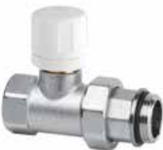
Valvola diritta cromata termostattizzabile. Attacco tubo ferro e codolo con O-ring.
