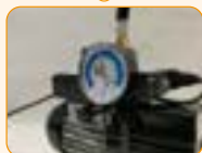
Collegamento con pompa per vuoto
