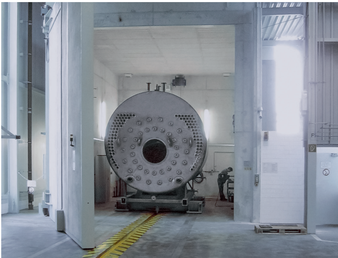
Nella camera a raggi X si rilevano eventuali difetti dei cordoni di saldatura o dei materiali dei singoli componenti della caldaia Vitomax
