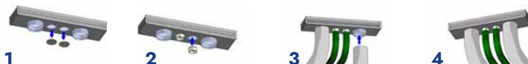
ES. INSTALLAZIONE BOCCHETTA LINEA CON RETE ARIA VMC (VERDE) RETE IDRONICA (GRIGIA)
