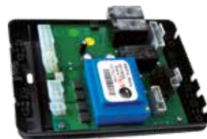
SCHEDA MODBUS 0-10 V 885IF Specifica per il collegamento a: termoregolatori con 0-10V, gestione cascata, moduli LonWorks, BACnet e dialogo MODBUS
