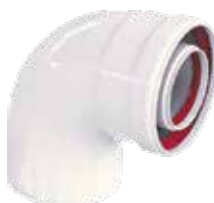
CURVA M.F. 90° Ø80/125 COASSIALE Esterno in alluminio Interno in polipropilene
