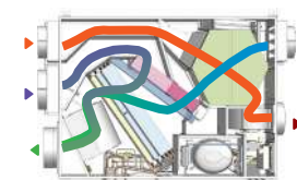
Flusso ricircolo, ricambio e trattamento aria
